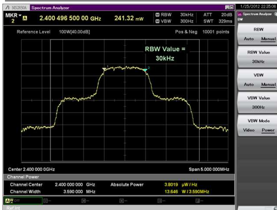
Figura 5 - Spettro all'uscita del PA. P_{out}=13.6 W
