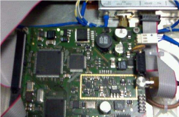
Foto 2 - Immagine al visibile del modulo DVB-S "miniMod- 2" della SR-System
