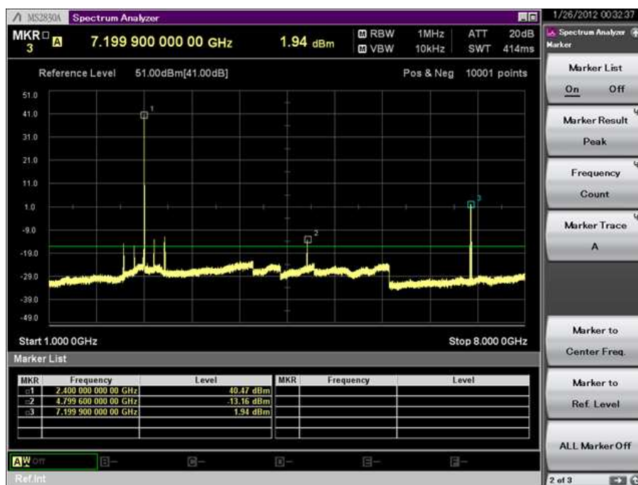
Figura 6 - Spettro all'uscita del PA osservato sulla banda 1-8 GHz. Pout=13.6 W
