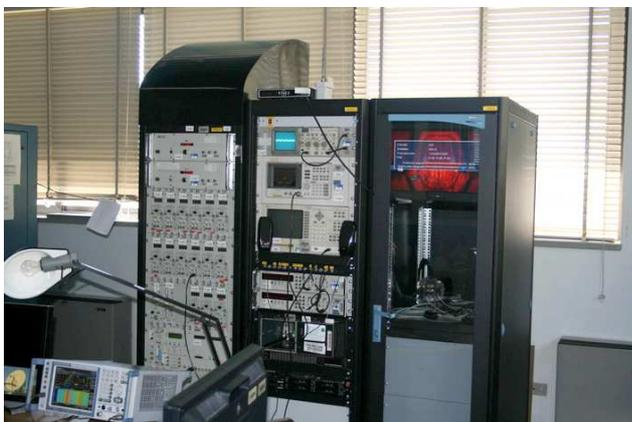
Prova del sistema ricevente nella sala controllo dell'antenna VLBI. Il ricevitore commerciale e il downconverter di prova è visibile sulla sommità del rack centrale. Sul monitor di destra è visibile il segnale trasmesso (2001 - odissea nello spazio)
