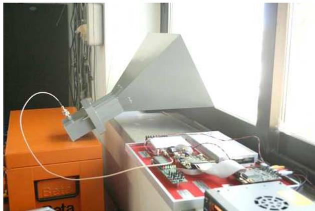
Dettaglio del trasmettitore HAM-TV. L'uscita del TX è connessa ad un'antenna a tromba che irradia il segnale verso l'antenna VLBI tramite una serie di attenuatori.
