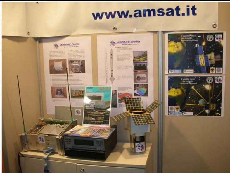
**Una vista “ravvicinata” della parte dello stand dove hanno trovato posto il nostro transponder educativo (TAI186), un amplificatore di potenza realizzato da un radioamatore di roma (professionalmente) ed il modello di AstroSat 1 (in scala 1:5). Sulla destra due poster di descrizione dei due satelliti AstroSat che ci vedono coinvolti con la UAI.**
