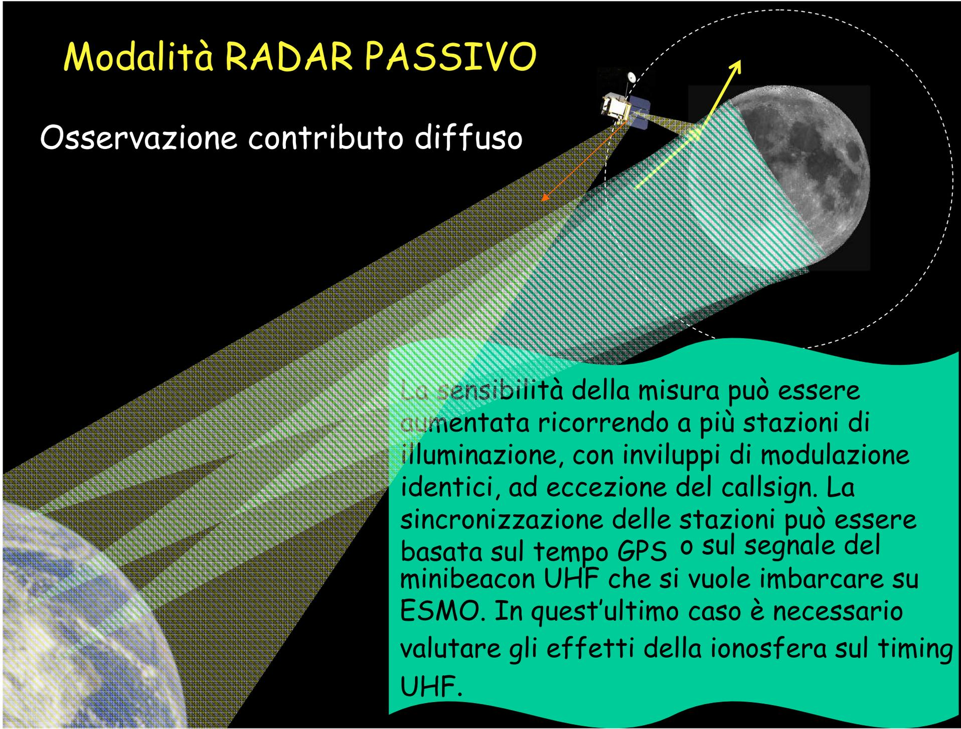
La sensibilità della misura può essere aumentata ricorrendo a più stazioni di illuminazione, con involucri di modulazione identici, ad eccezione del callsign. La sincronizzazione delle stazioni può essere basata sul tempo GPS o sul segnale del minibeacon UHF che si vuole imbarcare su ESMO. In quest'ultimo caso è necessario valutare gli effetti della ionosfera sul timing UHF.
