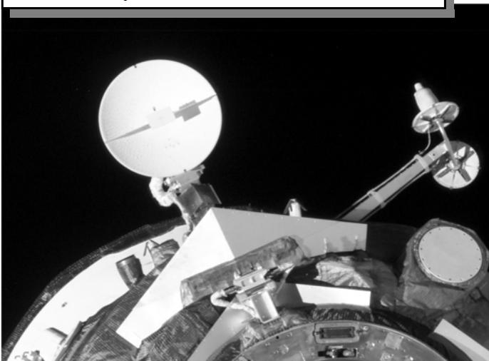
Stessa funzione viene svolta dallo schermo sotto all'antenna IGLA (visibile in dettaglio nella figura 11) proprio perchè i segnali arrivano dall'altro veicolo con angolo di zero gradi (equivalente all'orizzonte) e lo scafo li rifletterebbe in abbondanza, generando una grande quantità di echi.
