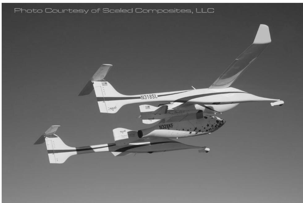
**Fig. 1: L'insieme del lanciatore (white Knight) e della navetta SpaceShipOne, durante le fasi iniziali dello storico volo 15P**
