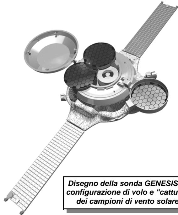
**Disegno della sonda GENESIS in configurazione di volo e "cattura" dei campioni di vento solare**
