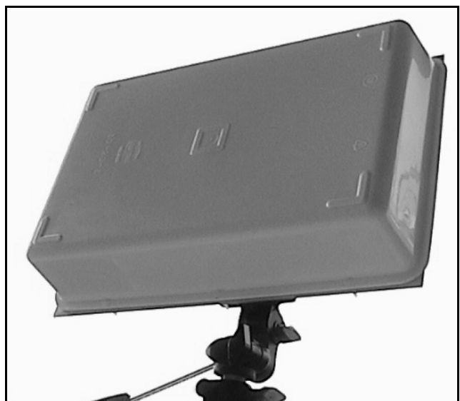
Fig.7: il sistema completo, racchiuso nella vaschetta "per alimenti" che gli conferisce un certo tono "professionale" e protegge i dipoli da urti accidentali (specie in portatile).
