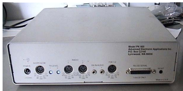
Fig.2: il pannello posteriore del PK900 con le numerose possibilità di collegamento alle radio ed al computer.
