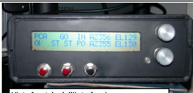
Vista frontale dell'interfaccia: sono visibili i tre pulsanti ed i potenziometri
