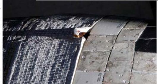
Dopo il distacco dalla ISS, alla fine dei suoi 13 giorni di missione, lo Shuttle è stato ispezionato visivamente per verificare che tutto il sistema termico di protezione sia integro, in vista del rientro, previsto per mercoledì 20 giugno.
