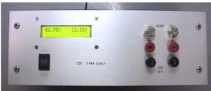
Fig. 1: Vista esterna dell'alimentatore "ringiovanito": si notano, sopra le boccole d'uscita, i due potenziometri multigiri di regolazione della tensione d'uscita, con dado di bloccaggio (recuperati da vecchi strumenti HP).
