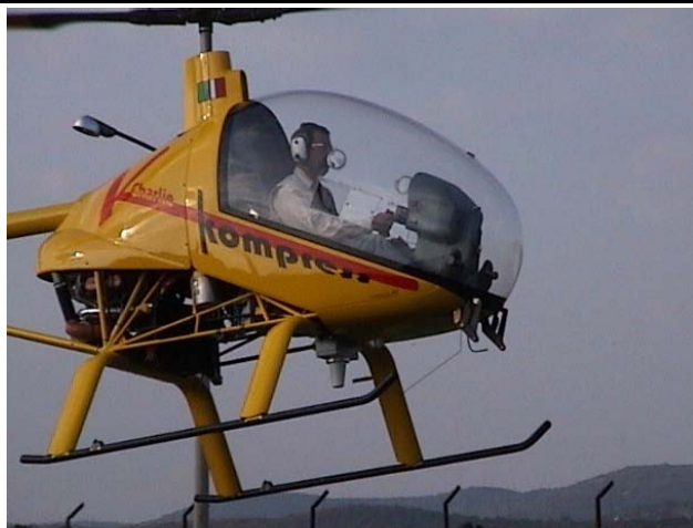
Fig. 4: il microTNC ed ilo tx ATV, installato nella scatola stagna completa di antenna, sotto la cabina dell'elicottero ultraleggero.
