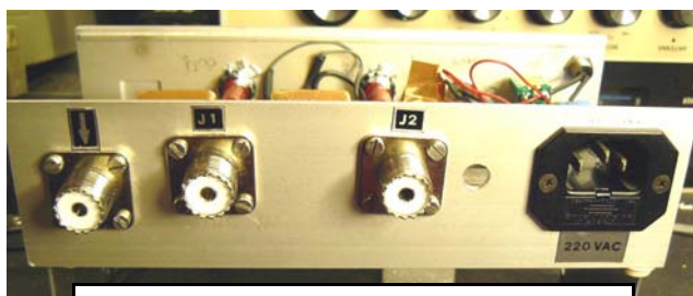
Fig.2: vista posteriore (lato connettori) del commutatore.
