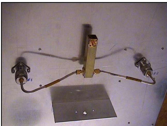
Fig. 7: Vista del collegamento di alimentazione delle antenne ed il partitore in quarto d'onda.
