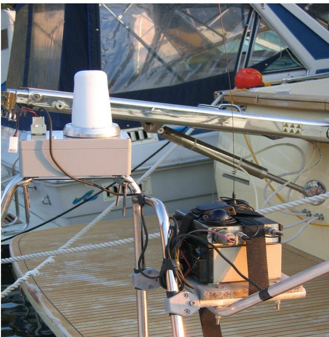
**Fig. 5: In alto a sinistra, il sistema trasmittente nella sua scatola stagna. A destra, più basso, il sistema APRS originale (in VHF) di IV3GCD.**
