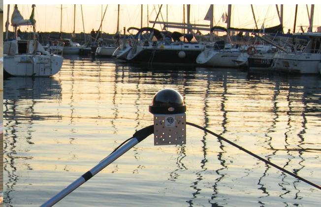
**Fig. 6: Il supporto con la telecamera, sistemato "alto" sulla poppa della barca.**
