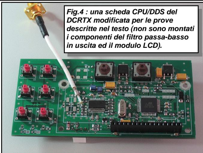
**Fig.4 : una scheda CPU/DDS del DCRTX modificata per le prove descritte nel testo (non sono montati i componenti del filtro passa-basso in uscita ed il modulo LCD).**
