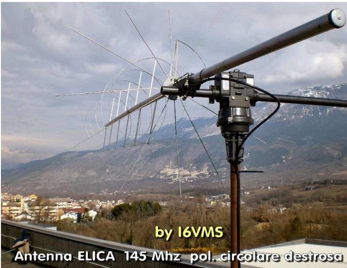
Antenna ELICA 145 Mhz pol. circolare destrorsa
